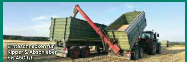
Fahrbare Schnecken mit Mittellagern bis 21m Länge
