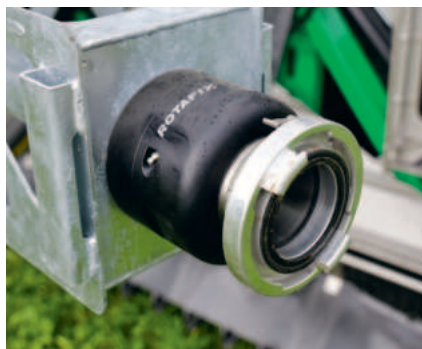
Dieses Axialdrehgelenk gegen das Verdrehen der Schläuche ist eine Eigenentwicklung.
