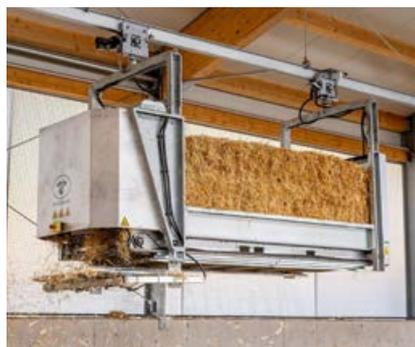
Das innovative Fütterungstechnik-Unternehmen, bietet auch den Einstreuroboter FLYPIT an. Das Besondere: In der 3m<sup>33</sup> Ausführung des Gerätes kann ein ganzer Quaderballen eingesetzt und verteilt werden.
