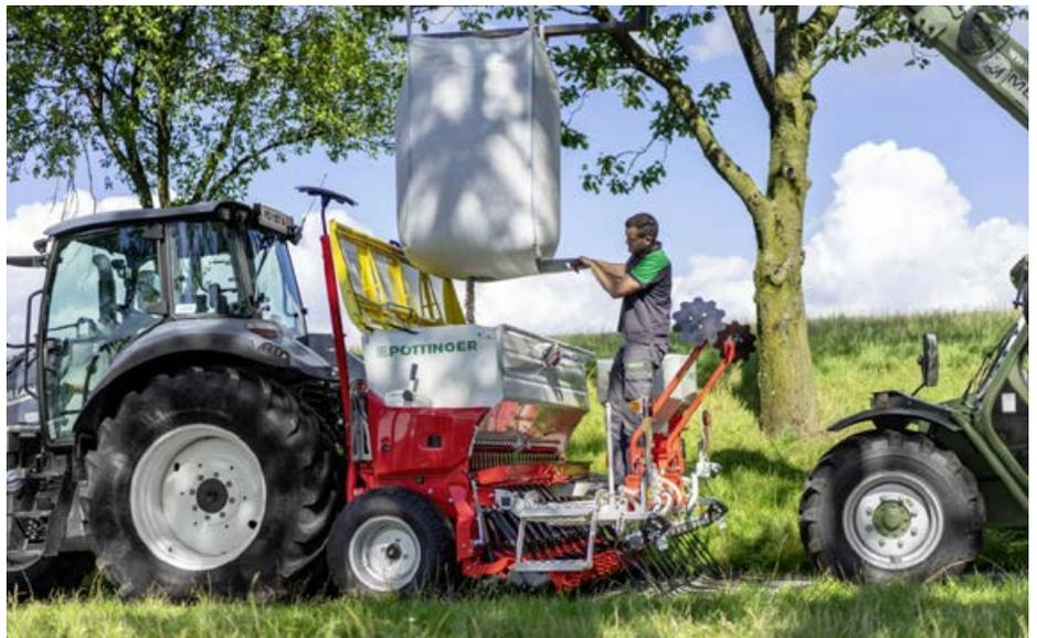
Großes Saattankvolumen für schnelle Saatgutnachfüllung und erhöhte Schlagkraft.
